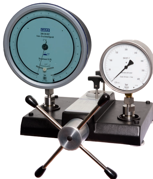
Комплект за калибриране CPP1200-X с измервателен уред като еталонен инструмент и изпитван елемент
