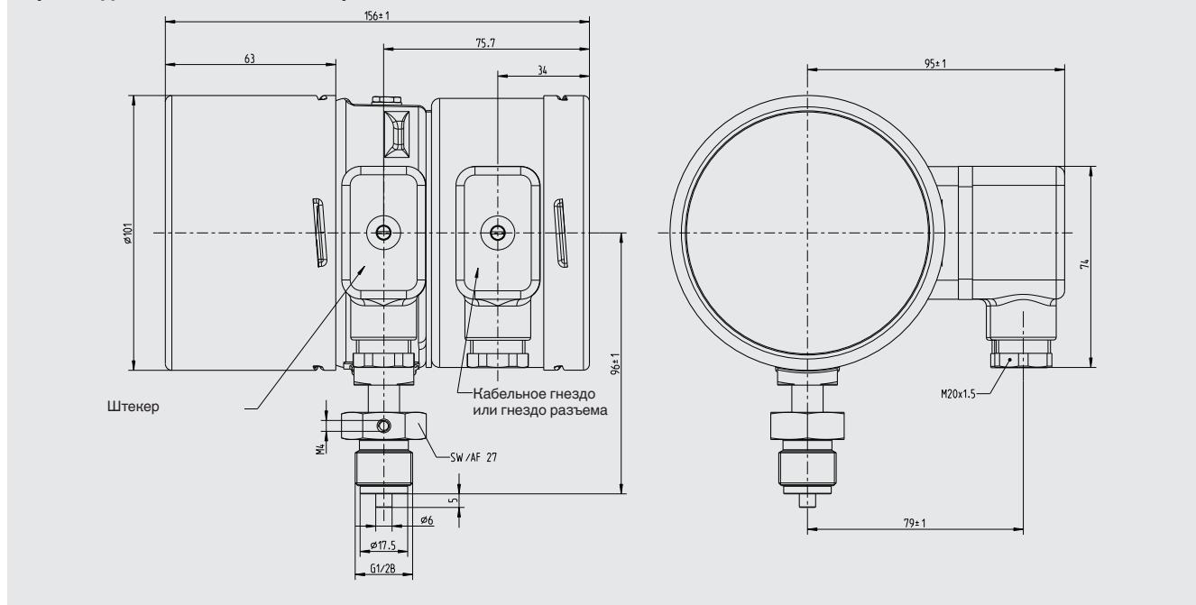
**Модель GDM-100-T с внешним цифровым преобразователем и вертикальным технологическим присоединением G ½ B**
