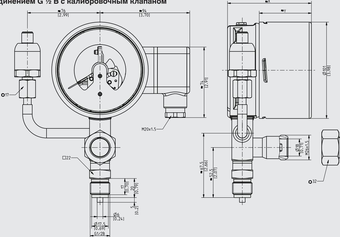
**Модель GDM-100-T с установленным сзади цифровым преобразователем и вертикальным технологическим присоединением G ½ В**
