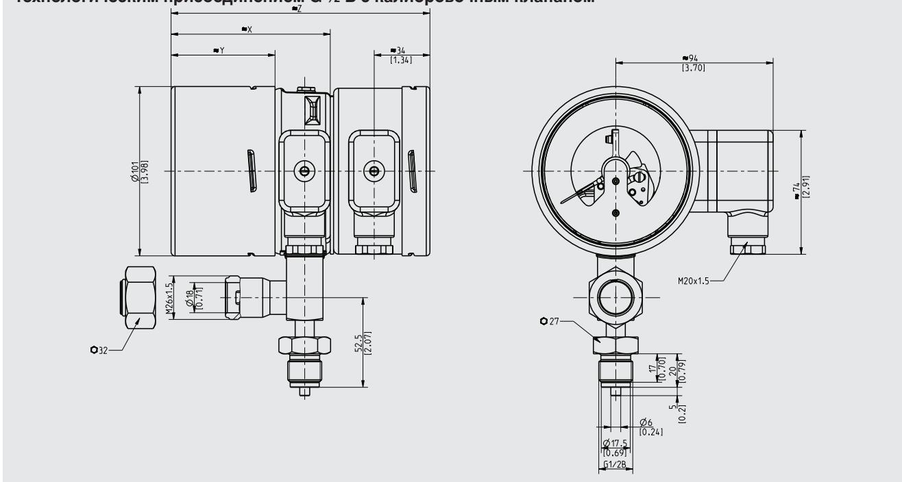
**Модель GDM-100-T с внешним цифровым преобразователем и вертикальным технологическим присоединением G ½ В с калибровочным клапаном**
