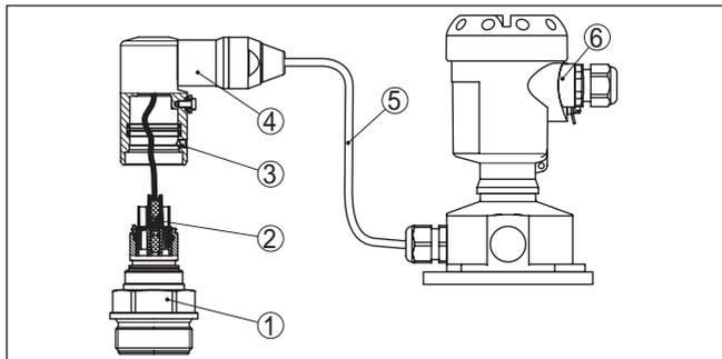
Fig. 35: CPT-2x como modelo IP68 de 25 bar e saída lateral do cabo, caixa externa
