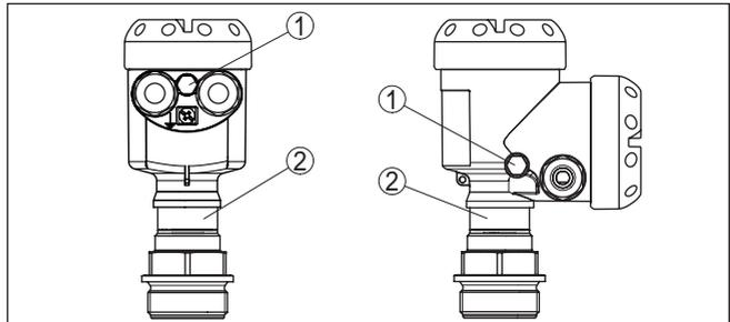
Fig. 13: Posição do elemento de filtragem - Passagem hermética
