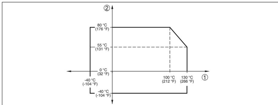
Fig. 38: Redução de temperatura CPT-2x, modelo até +130 °C (+266 °F)
