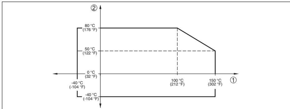
Fig. 39: Redução de temperatura CPT-2x, modelo até +150 °C (+302 °F)
