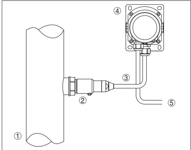
Fig. 19: Arranjo do módulo do processo, caixa externa
