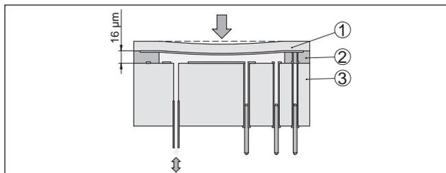
Fig. 3: Estrutura da célula de medição de cerâmica
