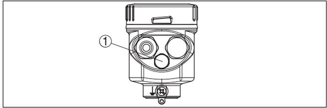
Fig. 14: Posição do elemento de filtragem - Modelo IP69K
