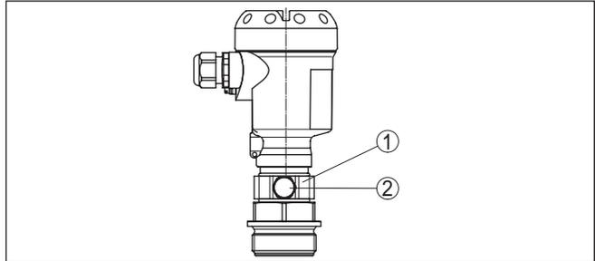
Fig. 12: Posição do elemento de filtragem - Modelo Ex-d
