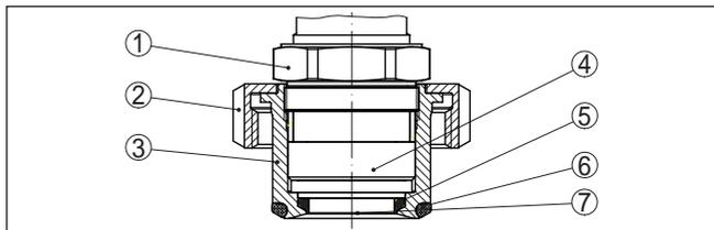
Fig. 33: CPT-2x, Estrutura conexão asséptica com porca de capa ranhurada
