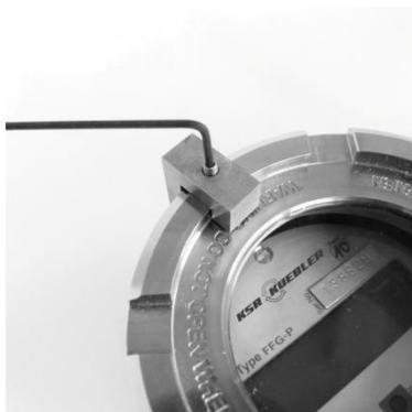
Bloqueie a tampa superior e inferior com os dois parafusos da trava de torção.
