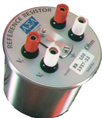
Resistenza campione modello CER6000-RR con 100 \Omega
